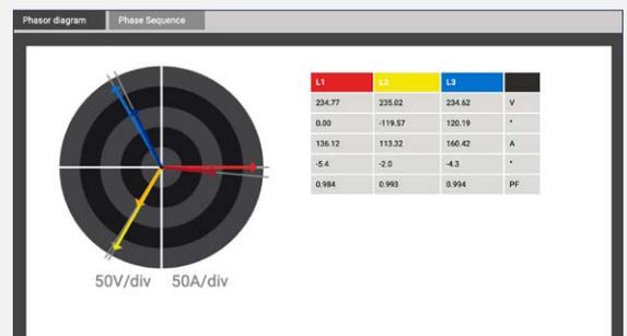
Diagramma vettoriale per il controllo dei collegamenti
